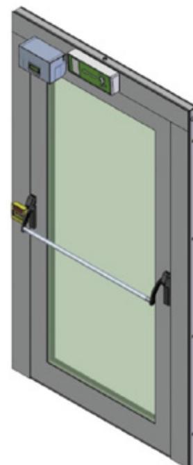
Elettromagnete utilizzato per bloccare l'apertura impropria di una porta/varco. Alimentando il magnete si ottiene il blocco, mentre l'apertura avviene automaticamente in mancanza di alimentazione o con comando da remoto.
