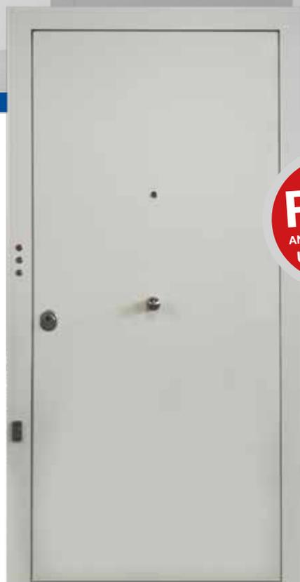
Porta in ferro, blindata, realizzata con lamiera esterne di acciaio (spessore 4 mm), con irrigidimenti strutturali interni, tubolari 25x25mm (spessore 2mm), certificata antintrusione classe RC4 secondo UNI EN 1627.
