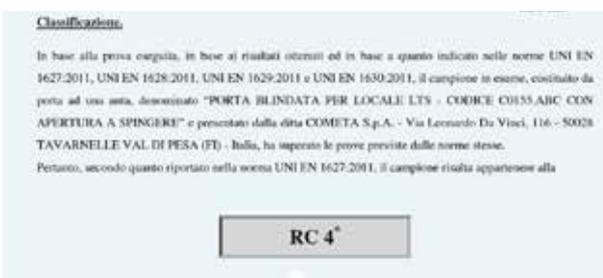
Porta blindata: certificata RC4 dall'*Istituto Giordano* secondo la normativa UNI EN 1627:2011 (relativa ai requisiti per le proprietà della resistenza all'effrazione di porte, porte pedonali, finestre, facciate continue, inferriate e chiusure oscillanti. Si applica ai tipi di aperture seguenti: a rotazione, basculante, a libro, a rototraslazione, sospese in alto o in basso, scorrevoli (orizzontalmente o verticalmente) e ad avvolgimento, così come strutture fisse).
