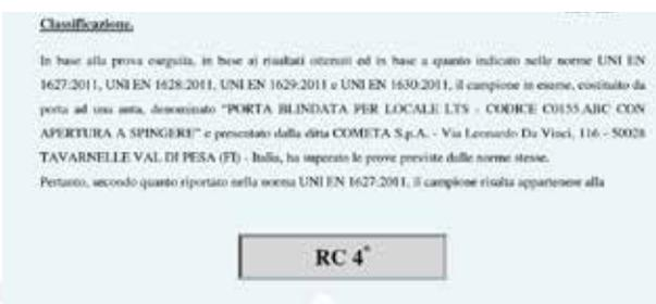
Porte blindée: certifiée RC4 par l'*Institut Giordano* selon la norme UNI EN 1627: 2011 (relative à exigences de résistance à l'effraction pour les portes, les fenêtres, les grilles et les fermetures à bascule).
